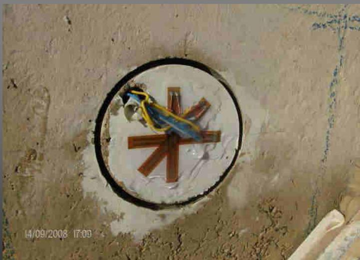
*Disposizione degli strain-gauges*
