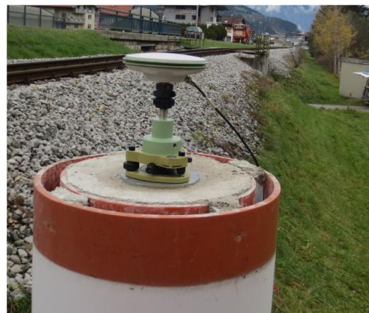
24h Beobachtungen mittels GNSS (GPS, Glonass, Galileo). (z.B. Wasserschloss KW Finsing, Zillertal)
